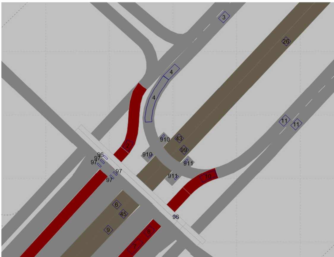
Figur 6 Detektornumrering i anl. 6885 – södra delen UA 1
